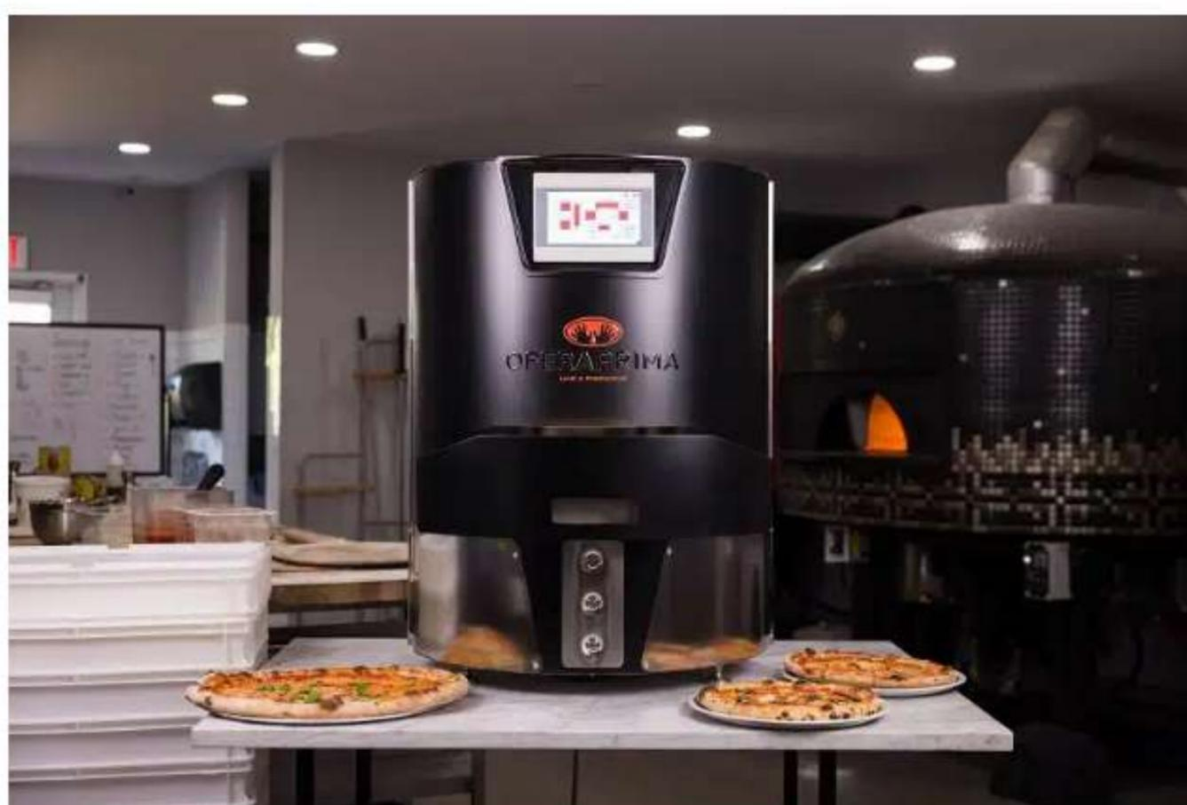
Anche se il panetto preparato non dovesse essere un cerchio perfetto, non è un problema perché OperaPrima è in grado di lavorarlo lo stesso. Permette di regolare il diametro di apertura per ottenere di volta in volta il risultato che si desidera. Lavora l'impasto, senza pressarlo o stressarlo, in soli 16 secondi, consentendo così di preparare fino a 200 pizze all'ora.
